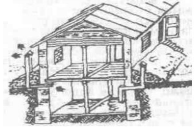
ПРУ в подвале
